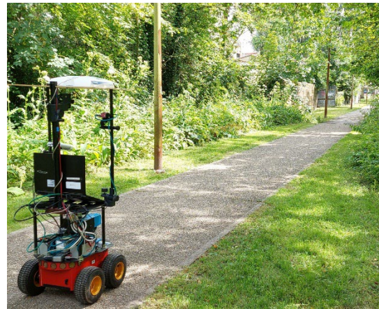
Figure 1 - Acquisition de données MuSeM : robot Pioneer 3-AT avec caméra multispectrale instantanée PhotonFocus, caméra RGB-D Microsoft Azure Kinect, Lidar SICK LMS200 et récepteur GNSS Trimble AG-372
